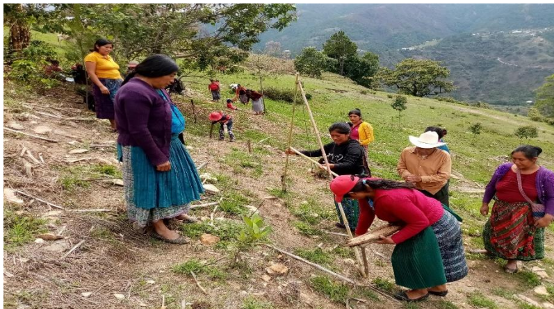
Prácticas de elaboración y calibración de agronivel y trazado de curvas a nivel con promotoras agropecuarias, Caserío La Unión, San Miguel Ixtahuacán.
